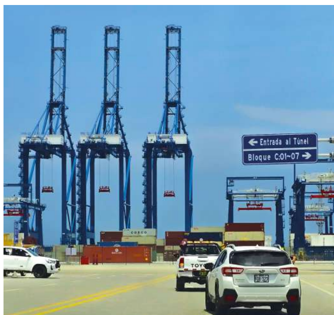
Figura nº 03: Sistema de guindastes de doca (Ship To Shore - STS) e guindastes de pátio (RMG) na área operacional da Cosco Shipping Ports Chancay Perú S.A.
